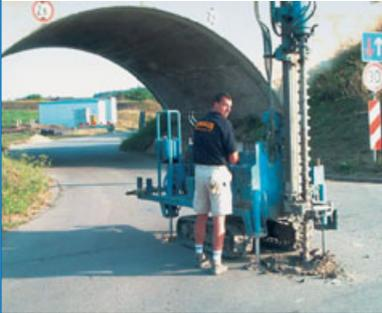
Abb. 7 Bohrlochsondierung
